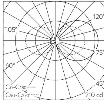
LED 3000 K 8.8 W 912 lm-h / CIE Flux 13 37 66 50 100 / C11 nach DIN 5040
