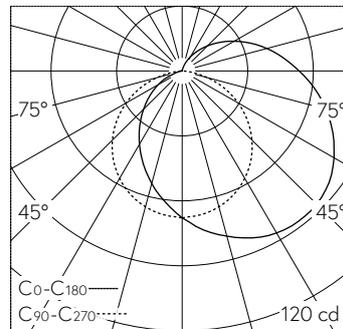
LED 3000 K 5.9 W 296 lm-h / CIE Flux 38 67 87 84 100 / B31 nach DIN 5040
