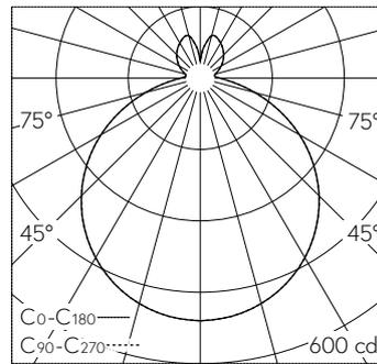
LED 3000 K 19.6 W 1900 lm-h / CIE Flux 45 75 92 82 100 / B43 nach DIN 5040
