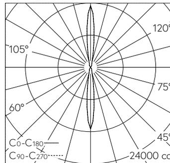
LED 3000 K 40 W 3300 lm-h / CIE Flux 99 100 100 50 100 / C84 nach DIN 5040
