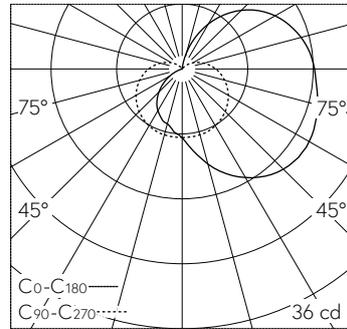
LED 3000 K 1.6 W 80 lm-h / CIE Flux 27 54 78 68 100 / B21 nach DIN 5040
