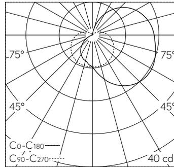
LED 4000 K 1.6 W 82 lm-h / CIE Flux 27 54 78 68 100 / B21 nach DIN 5040
