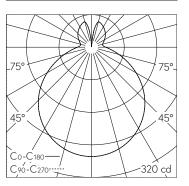
LED 3000 K 9 W 877 lm-h / CIE Flux 43 73 90 77 100 / B32 nach DIN 5040
