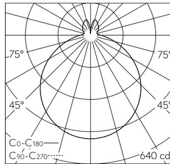
LED 4000 K 15.5 W 2184 lm-h / CIE Flux 44 75 92 84 100 / B42 nach DIN 5040
