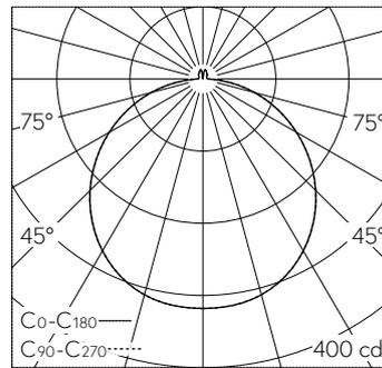
LED 3000 K 9 W 802 lm-h / CIE Flux 46 76 94 95 100 / A42 nach DIN 5040
