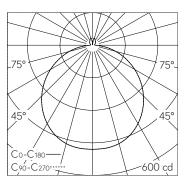
LED 4000 K 15.4 W 1811 lm-h / CIE Flux 46 76 94 94 100 / A42 nach DIN 5040
