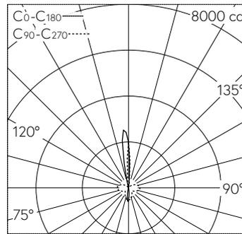
LED 3000 K 19,5 W 671 lm-h / CIE Flux 48 62 79 59 100 / C42 nach DIN 5040
