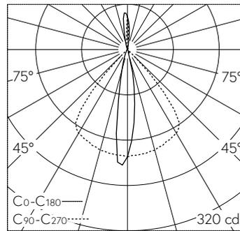
LED 3000 K 12.3 W 216 lm-h / CIE Flux 95 100 100 97 100 / A84 nach DIN 5040
