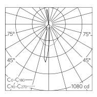
LED 4000 K 12.3 W 238 lm-h / CIE Flux 90 100 100 97 100 / A84 nach DIN 5040
