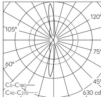
LED 4000 K 13.5 W 959 lm-h / CIE Flux 43 67 84 50 100 / C33 nach DIN 5040
