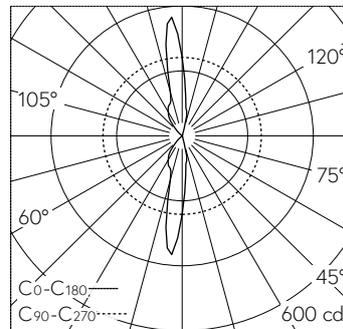
LED 3000 K 13.5 W 874 lm-h / CIE Flux 43 67 84 50 100 / C33 nach DIN 5040
