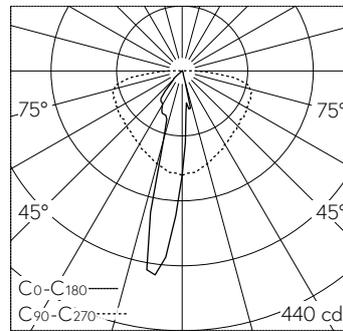
LED 4000 K 6.7 W 316 lm-h / CIE Flux 50 74 90 100 100 / A40 nach DIN 5040
