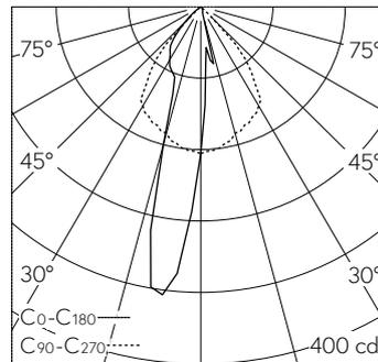
LED 4000 K 6.7 W 164 lm-h / CIE Flux 89 100 100 100 100 / A80 nach DIN 5040
