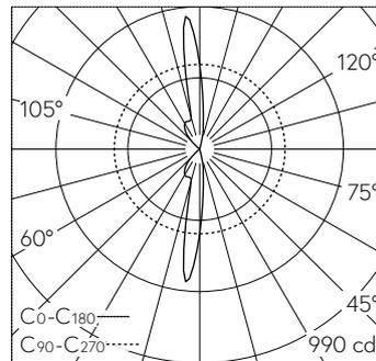
LED 3000 K 23 W 1262 lm-h / CIE Flux 45 68 84 50 100 / C33 nach DIN 5040
