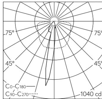
LED 4000 K 12.3 W 631 lm-h / CIE Flux 49 73 89 100 100 / A40 nach DIN 5040
