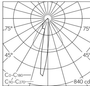
LED 3000 K 12.3 W 291 lm-h / CIE Flux 90 100 100 100 100 / A80 nach DIN 5040
