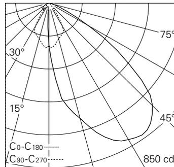
LED 3000 K 9.5 W 820 lm-h / CIE Flux 67 96 100 100 100 / A60 nach DIN 5040
