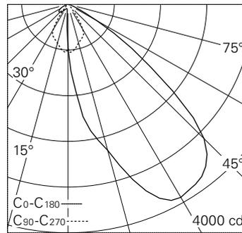
LED 3000 K 36.1 W 2879 lm-h / CIE Flux 70 98 100 100 100 / A60 nach DIN 5040
