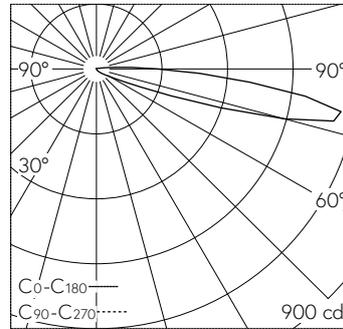
LED 4000 K 6.1 W 305 lm-h / CIE Flux 1 4 28 91 100 / A11 nach DIN 5040
