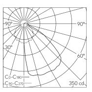
LED 3000 K 4.9 W 350 lm-h / CIE Flux 48 85 98 98 100 / A41 nach DIN 5040
