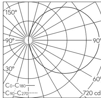
LED 4000 K 36.4 W 1883 lm-h / CIE Flux 13 37 66 50 100 / C11 nach DIN 5040
