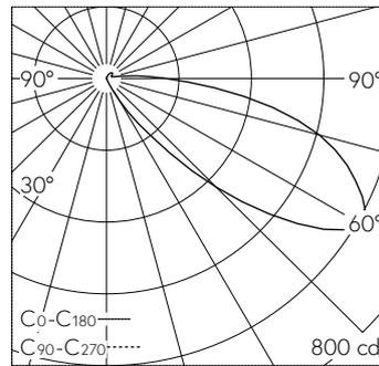
LED 3000 K 7 W 615 lm-h / CIE Flux 6 43 81 93 100 / A11 nach DIN 5040
