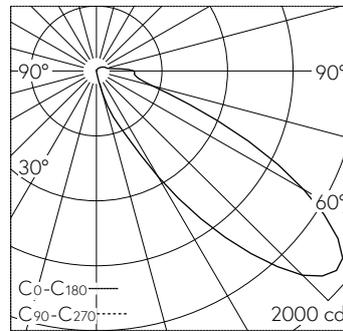
LED 4000 K 17.3 W 1690 lm-h / CIE Flux 23 70 91 93 100 / A21 nach DIN 5040
