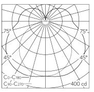
LED 3000 K 14.7 W 1847 lm-h / CIE Flux 36 65 86 74 100 / B31 nach DIN 5040
