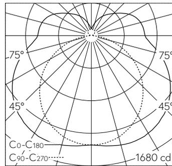
LED 4000 K 55 W 7710 lm-h / CIE Flux 36 66 86 75 100 / B31 nach DIN 5040
