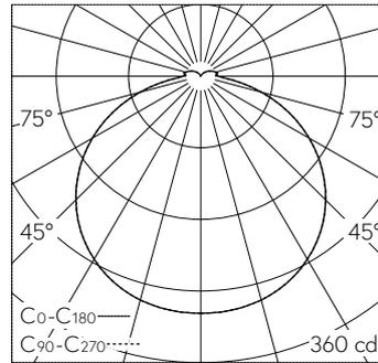
LED 3000 K 19 W 1111 lm-h / CIE Flux 43 74 92 93 100 / A31 nach DIN 5040
