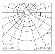
LED 4000 K 38.1 W 5948 lm-h / CIE Flux 26 51 75 55 100 / C12 nach DIN 5040
