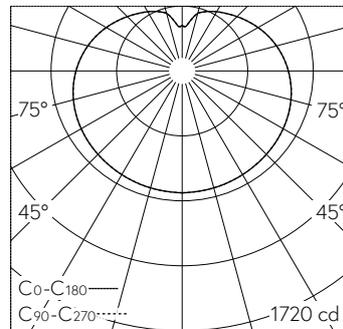
LED 4000 K 50.2 W 8317 lm-h / CIE Flux 26 52 76 57 100 / C22 nach DIN 5040
