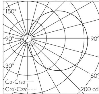
LED 4000 K 6.6 W 588 lm-h / CIE Flux 19 44 71 55 100 / C11 nach DIN 5040
