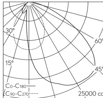
LED 3000 K 298 W 27704 lm-h / CIE Flux 57 88 98 100 100 / A50 nach DIN 5040
