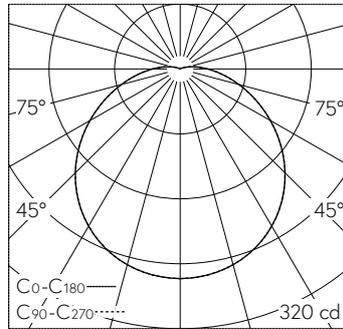
LED 3000 K 9 W 881 lm-h / CIE Flux 42 72 90 96 100 / A30 nach DIN 5040
