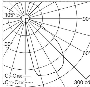
LED 3000 K 4.8 W 273 lm-h / CIE Flux 43 82 97 99 100 / A40 nach DIN 5040
