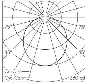
LED 3000 K 8.1 W 677 lm-h / CIE Flux 45 75 92 96 100 / A41 nach DIN 5040
