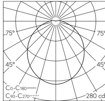
LED 3000 K 8.1 W 712 lm-h / CIE Flux 45 75 92 96 100 / A41 nach DIN 5040
