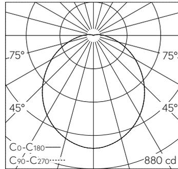
LED 4000 K 26.5 W 2241 lm-h / CIE Flux 45 75 91 96 100 / A40 nach DIN 5040
