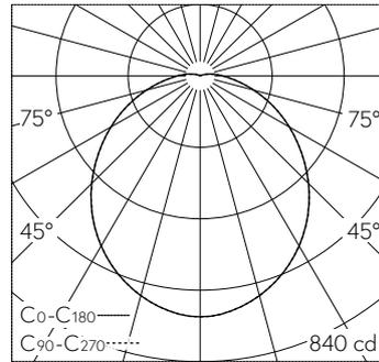
LED 3000 K 26.5 W 2131 lm-h / CIE Flux 45 75 91 96 100 / A40 nach DIN 5040
