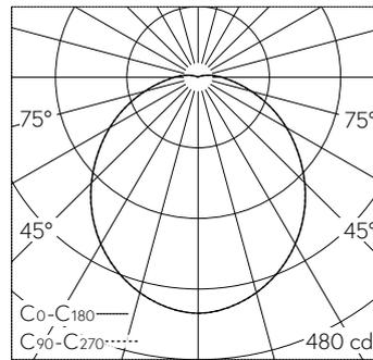
LED 4000 K 14.5 W 1217 lm-h / CIE Flux 45 74 91 96 100 / A40 nach DIN 5040
