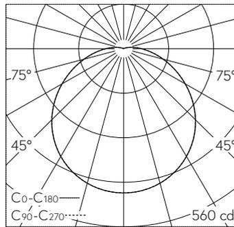
LED 4000 K 15.7 W 1450 lm-h / CIE Flux 43 72 90 96 100 / A30 nach DIN 5040
