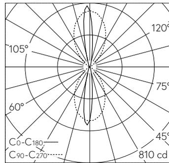
LED 4000 K 11.5 W 403 lm-h / CIE Flux 87 98 100 50 100 / C84 nach DIN 5040
