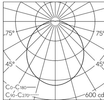
LED 4000 K 14.5 W 1425 lm-h / CIE Flux 46 75 92 97 100 / A40 nach DIN 5040
