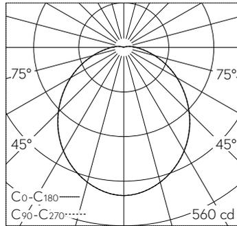
LED 3000 K 15.7 W 1356 / CIE Flux 46 75 92 97 100 / A40 nach DIN 5040
