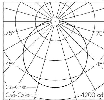
LED 3000 K 26.5 W 3242 lm-h / CIE Flux 44 74 91 97 100 / A30 nach DIN 5040
