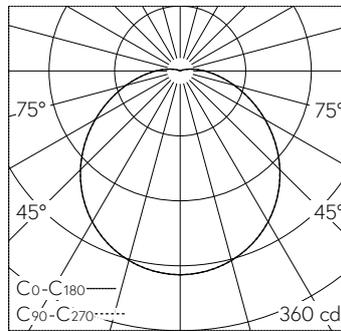
LED 3000 K 9 W 933 lm-h / CIE Flux 43 73 90 96 100 / A30 nach DIN 5040
