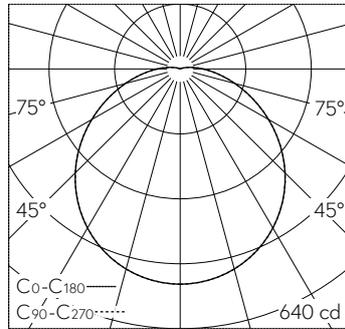
LED 3000 K 15.7 W 1717 lm-h / CIE Flux 44 73 91 97 100 / A30 nach DIN 5040
