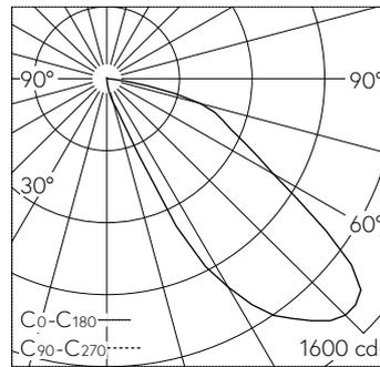
LED 4000 K 14 W 1266 lm-h / CIE Flux 25 71 94 100 100 / A20 nach DIN 5040
