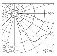
LED 4000 K 4 W 471 lm-h / CIE Flux 18 51 83 96 100 / A11 nach DIN 5040
